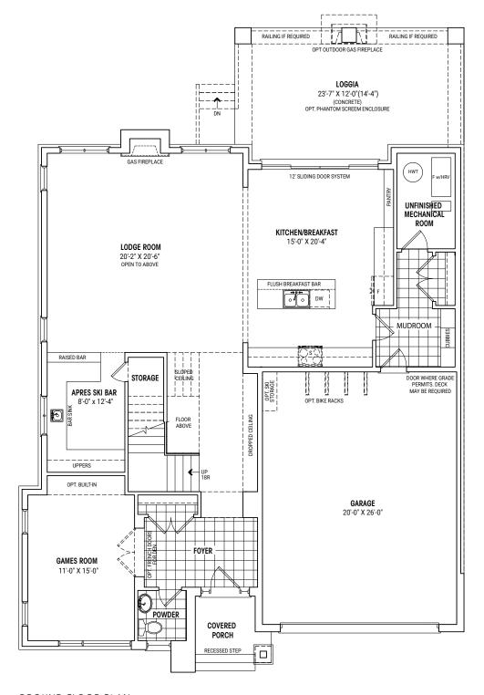
GROUND FLOOR PLAN ELEVATION B
